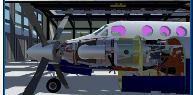
Comparación de la precisión del modelo 3D del motor de la aeronave, contra el motor real de la misma el PT6A-60A
